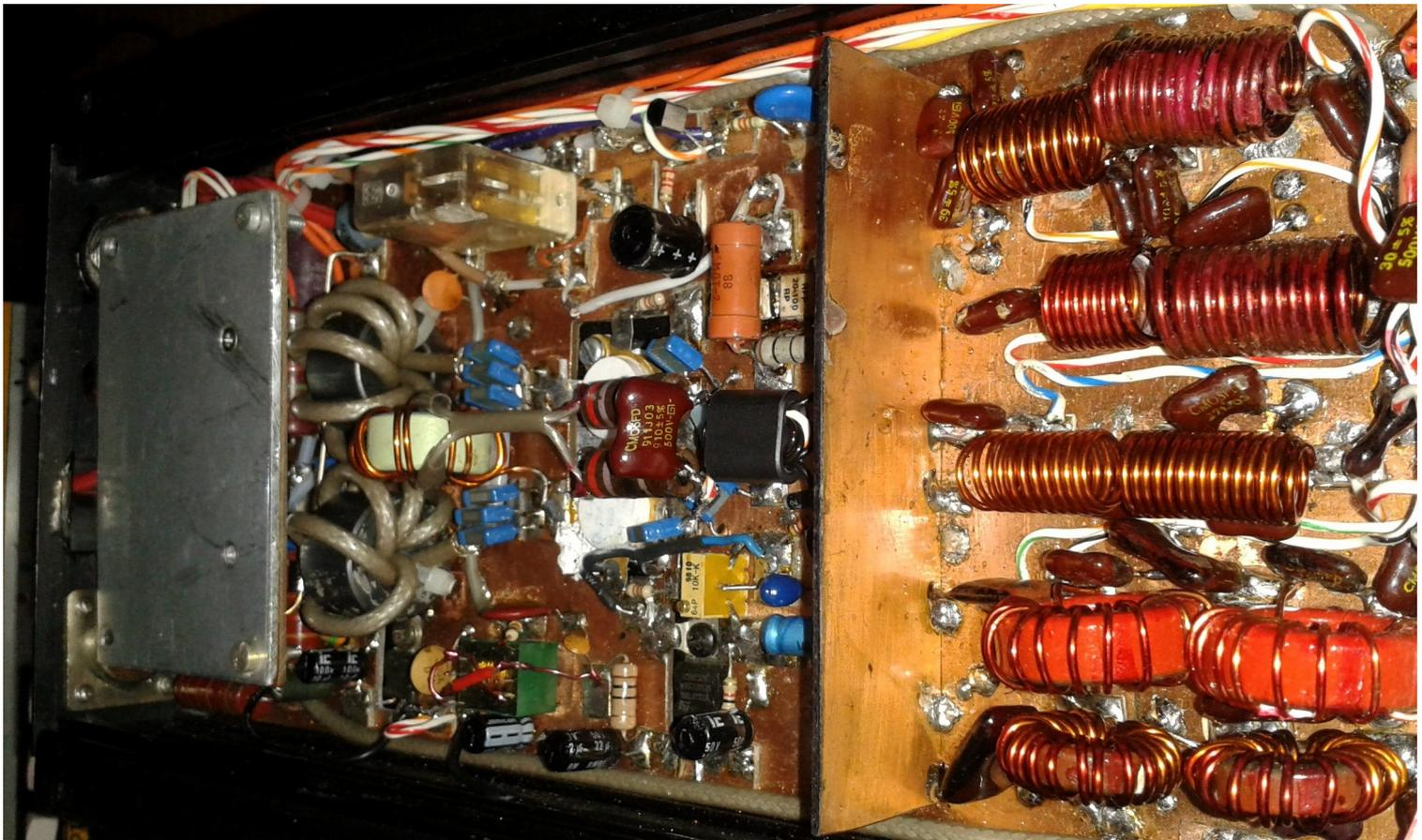
**Fig 12: Amplificador terminado con la placa protectora en su interior.**
