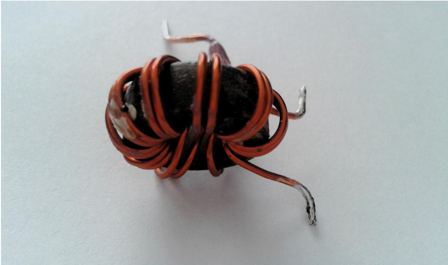
**Fig 16 : Choque de alimentación T-2 consistente en un devanado bifilar de 8 espiras.**
