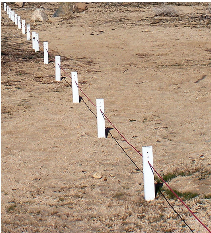
El reflector parásito de 5 MHz atraviesa estacas de madera. El elemento pasivo no está puesto a tierra ni cableado al dipolo.
