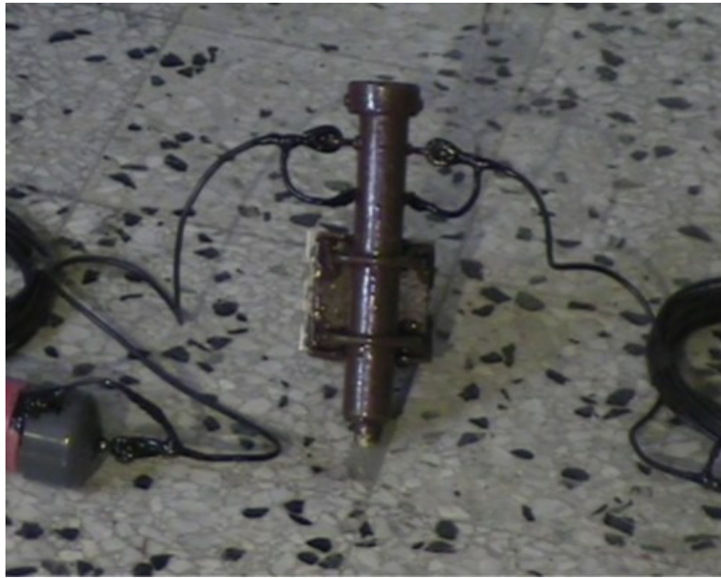
Fig 2: Aislador central con choque de RF en el interior
