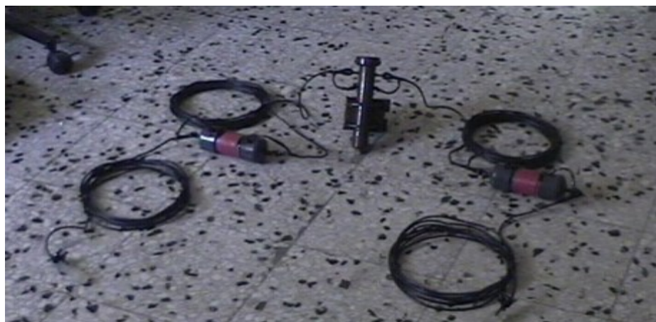
Fig 5: Conjunto de antena sin la protección final de las trampas
