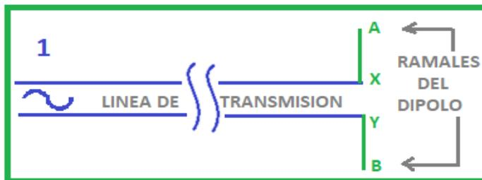
y a partir de ahí se forman los ramales A y B de la antena. Los puntos X e Y los vamos a llamar Terminales de Conexión, o PUNTOS DE ALIMENTACIÓN de la antena.
