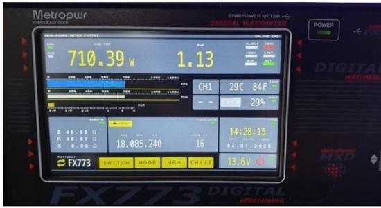
disponibles medidores de ROE con watímetro incorporado, a un precio equivalente a un buen medidor de agujas. Te proporciona la indicación de Potencia directa, (FWD), ROE en formato SWR, y potencia reflejada de retorno, (REF), todo a un golpe de vista. No tiene la fragilidad
