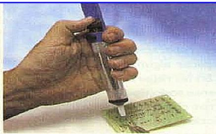
2) Se presiona el botón superior del desoldador hasta que el pistón quede asegurado
