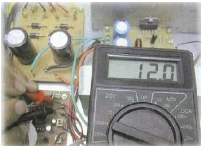
corde en la pista del circuito impreso. el cual se debe restituir una vez se haya hecho la medición, y en el segundo caso. se debe desoldar el terminal seleccionado para la medida.
