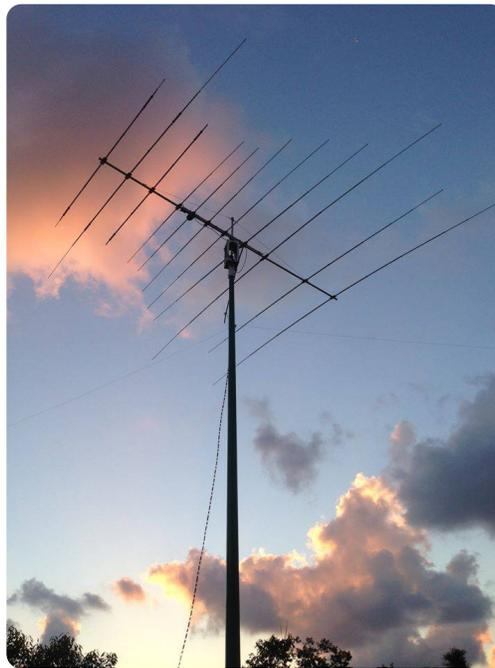
para emisión es el mismo para recepción. Una antena directiva ayuda a eliminar señales de las direcciones no deseadas, además de aumentar la fuerza de las señales recibidas por la dirección deseada. Se utiliza con frecuencia el término ganancia para referenciar el incremento de señal o de intensidad de campo que ofrece una antena directiva con respecto a una antena dipolo en el espacio libre (o a otra antena teórica en el espacio libre llamada antena isotrópica).
