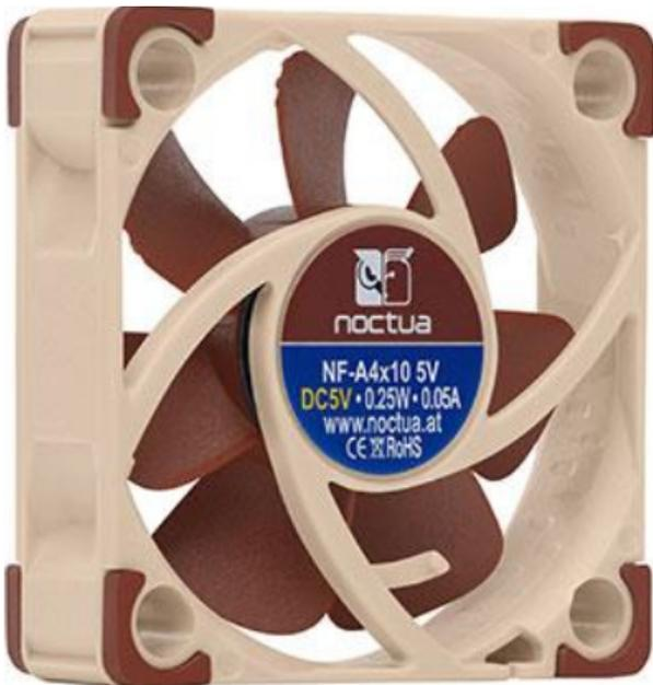
Inicialmente, para usar con un punto de acceso que es un sombrero de radio / módem montado en un RPi, soldé los conectores a los pines RPi GPIO 4 5V y 6 GND (para un buen diagrama, ver: **Raspberry Pi Pinout** . Posteriormente, comencé a usar el truco Fan SHIM discutido anteriormente.
