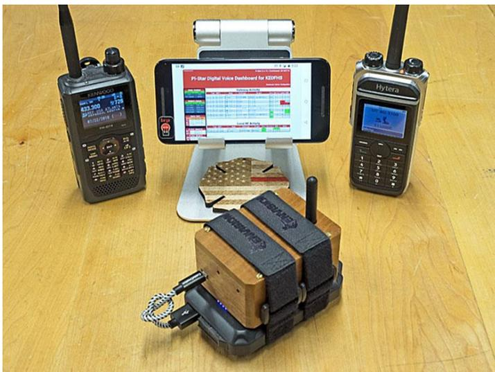
Agregué un adaptador micro-USB en ángulo recto dentro de la caja para facilitar la conexión (el puerto del complemento se alinea mejor con el puerto del cargador portátil), así como para reducir el desgaste del puerto micro USB del RPi. El estuche de caoba se adapta perfectamente a la parte superior de la batería, unido con correas de cincha Soft Touch
