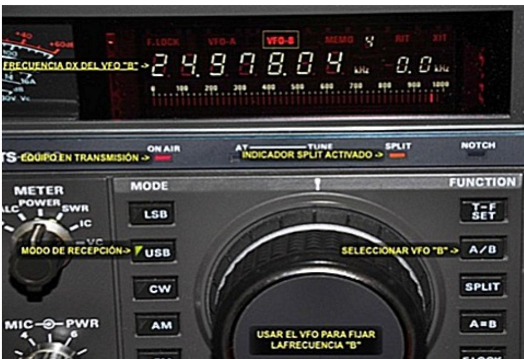
!El montaje mas deseado es tener lo que se conoce como un “sub-receiver o sub-receptor”! Esto te da verdadera capacidad de transmitir en una frecuencia, recibir en esa misma frecuencia y al mismo tiempo, recibir en otra frecuencia. Hablaremos mas de las ventajas del sub-receptor en un minuto.
