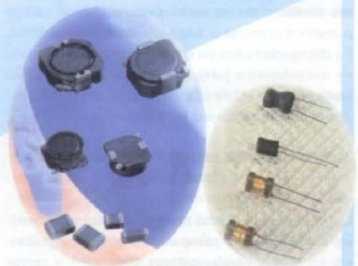
Figura 8.8. Bobinas para montaje superficial y montaje por inserción
