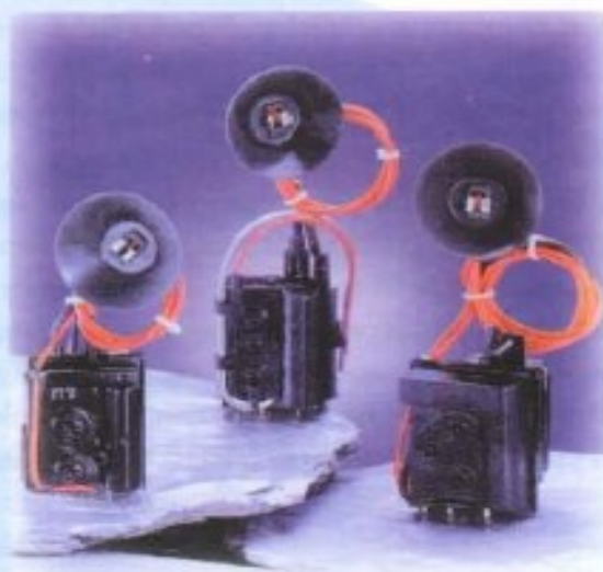
Figura 8.17. Transformadores elevadores de voltaje
