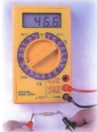
Figura 6.9. Prueba de las resistencias con el multímetro
