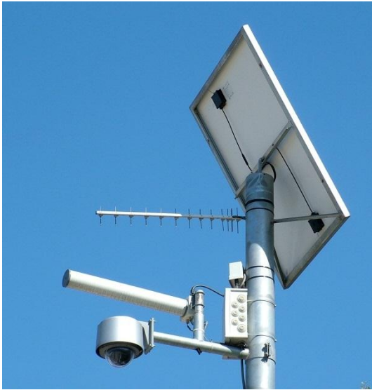
Fig. 208 Sistema de telemetría para emitir de datos de video utilizando una antena Yagi-Uda operando alrededor de los 2.5GHz. Su directividad y sencillez del sistema de alimentación resulta útil per radioenlaces en lugar de instalar un cableado costoso en cuanto a infraestructura. Gentileza del Dr. Edouard Rozan de la empresa Wireless BCN de Barcelona
