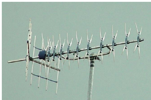
Fig. 245 Izquierda: esquema básico de un reflector diédrico. La fuente se sitúa a una distancia d del vértice. El ángulo del reflector es \alpha . Derecha: aplicación de un reflector diédrico simplificado con varitas para aumentar la directividad de una agrupación Yagi-Uda. Notáis que las varitas tienen el mismo sentido que la polarización de la antena y es vertical en este caso.
