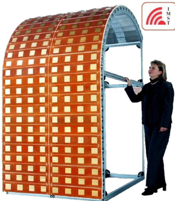
Fig. 187 Array de antenas microstrip con barrido de eje electrónico en banda L para comunicaciones satélite - marítimas. Gentileza de la Dra. Marta Martínez de IMST, Alemania
