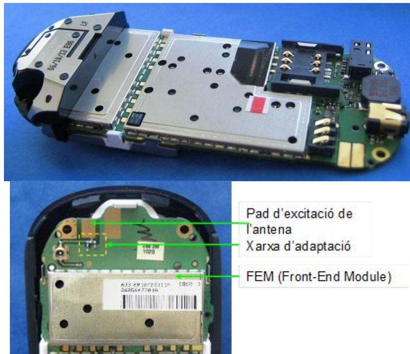
Fig. 69 Teléfono móvil que muestra la antena (extremo izquierda) y detalle de la PCB (Printed Circuit Board).
