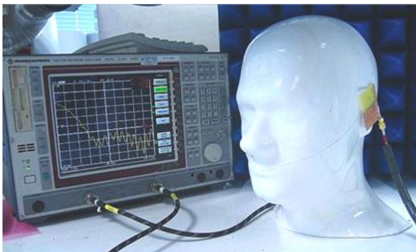
Fig. 20 Analizador de redes para la medida del coeficiente de reflexión de antenas. El ejemplo muestra la medida de una antena enganchada a la mejilla de un phantom head (maniquí de cabeza humana) que contiene líquidos que emulan el tejido humano. Gentileza de la empresa de tecnología Fractus, Barcelona.
