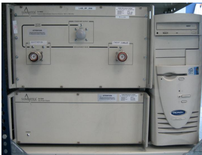
Fig. 177 Aparato de PIM: medida de productos de intermodulación. Gentileza de la empresa de tecnología Fractus, Barcelona.
