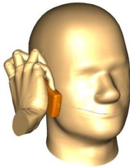
Fig. 97 Las antenas de telefonía móvil sufren en general alteraciones de su impedancia y reducción de la eficiencia de radiación debido a que la cabeza es un medio dieléctrico con pérdidas.
