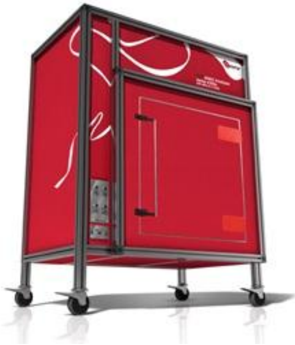
Fig. 203 Cámara de reverberación para la medida de sistemas con múltiples antenas: sistemas de diversidad i MIMO. Gentileza del profesor David A. Sánchez del Dept. Teoría de la Señal y Comunicaciones de la Universidad Politécnica de Cartagena y de la empresa EMite Ing, Murcia.
