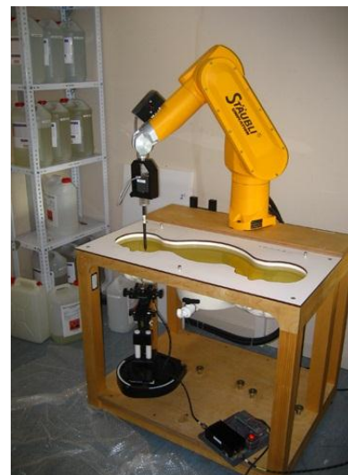
Fig. 100 Sistema de medida de SAR Dasy-4 que consta de un brazo articulado con una sonda de campo eléctrico que permite medir E_x , E_y y E_z a partir de dipolos elementales. Gentileza de la empresa de tecnología Fractus, Barcelona.
