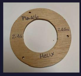
Para realizar el reflector, yo he usado placa PCB de una sola cara, la he recortado con el molde y preparado los agujeros
