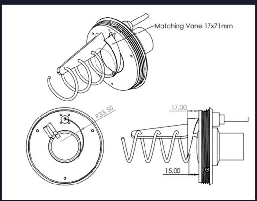
De este modo podemos ajustar la roe a la antena. Recomiendo usar latón para hacer el adaptador, permite ajustar mejor.
