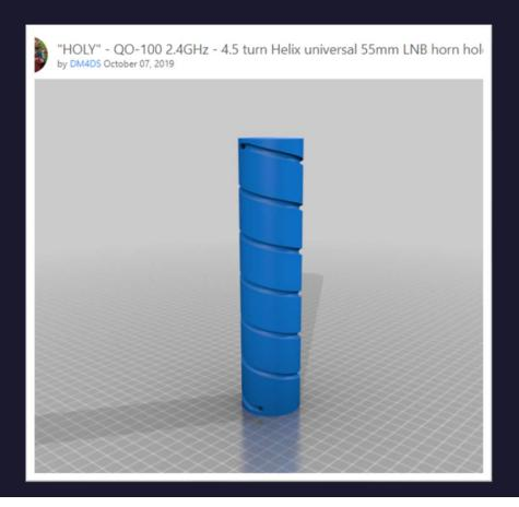
Para empezar con la construcción de la antena he estado buscando métodos para la creación de la espira. Después de ver varios, me he decantado por realizar un molde con la impresora 3D y así poder realizar al milímetro las espiras sin problema.
