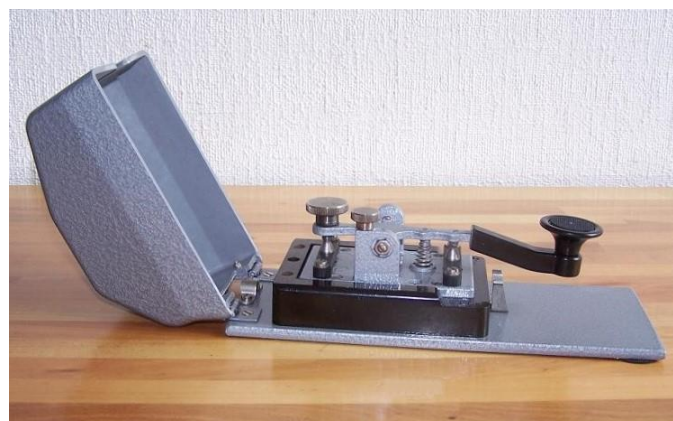
Manipulador de código Morse como los utilizados en LSA
